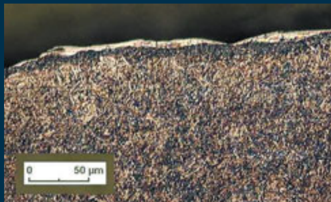
Oberflächenaussehen nach Senkerodieren mit Kupfer-Elektrode Surface finish following spark eroding with a copper electrode
